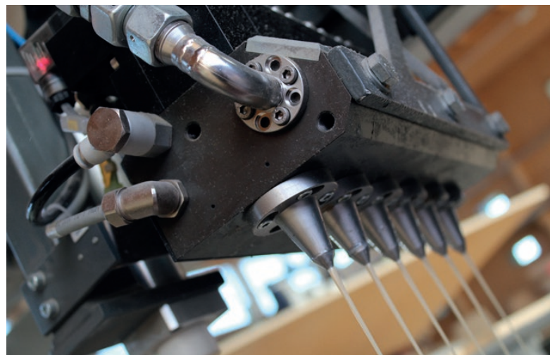
1C PUR接着剤塗布用マルチノズルの詳細。
