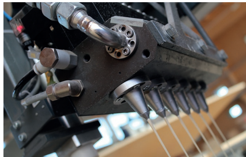
Particolare degli ugelli multipli per l'applicazione degli adesivi PUR monocomponenti.
