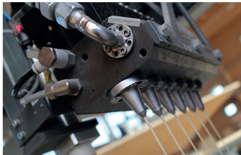
Vista detallada de las boquillas múltiples para la aplicación de adhesivo 1K- PUR.
