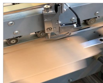
Nakładanie płynu do bigowania SpeedUp na linię zagięcia
