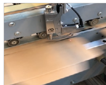
Applicazione del liquido cordonatore SpeedUp sulla linea di piega
