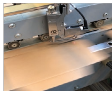
Application du liquide de rainage SpeedUp sur la ligne de pliage
