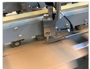
Auftrag der Rillflüssigkeit SpeedUp auf die Falzlinie
