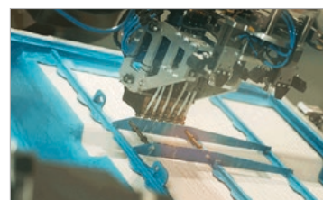
ロボットによるバッテリーカバーへの複数のビード塗布
