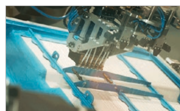
Application robotisée de plusieurs couches de revêtement rugueux pour les couvercles de batterie
