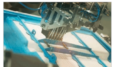
Aplicación múltiple de rugosidad asistida por robot para cubiertas de baterías
