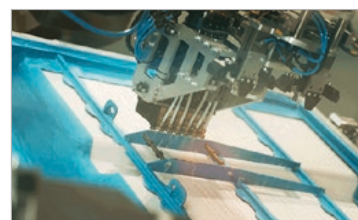
Robotergestützter Mehrfach-Raupenauftrag für Batterieabdeckungen
