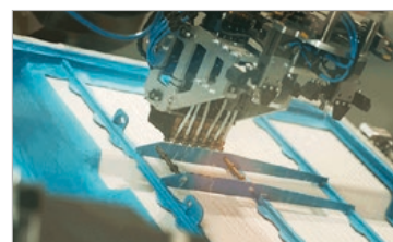
机器人辅助多头喷枪粘合电池盖板
