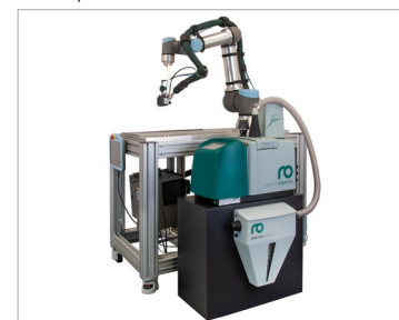
Cobot z systemem do nanoszenia kleju i automatycznym napełnianiem
