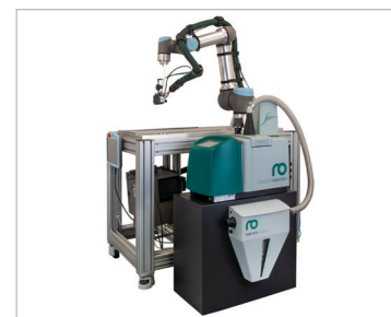
協働ロボットと接着剤塗布システムおよび自動充填
