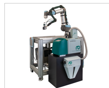
Cobot avec système d'application de colle et système de remplissage automatique
