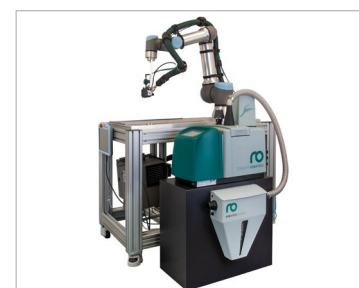
Cobot con sistema de aplicación de adhesivo y llenado automático
