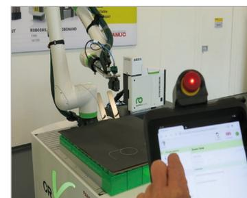
Cobot con sistema di applicazione di adesivo e visualizzazione web-based
