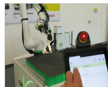
Cobot con sistema de aplicación de adhesivo y visualización basada en la web
