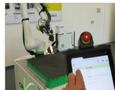
Cobot mit Klebstoff-Auftragssystem und webbasierter Visualisierung
