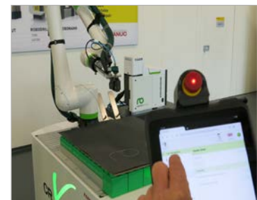
Cobot mit Klebstoff-Auftragssystem und webbasierter Visualisierung
