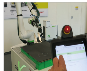
配备喷胶系统、提供网络可视化的协作机器人
