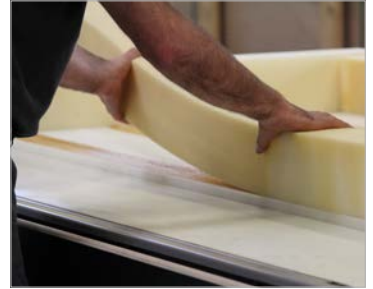
Yan döşemelerin yapıştırılması
