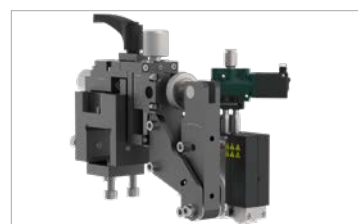
ロバテックサスペンションシステム：xおよびy方向と傾きに正確。左または右に取り付け可能
