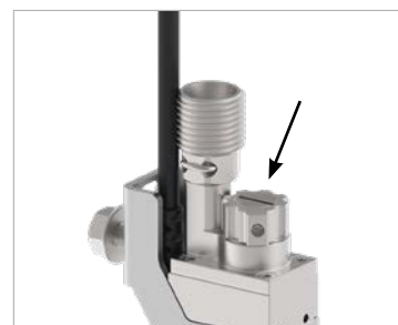
Ajuste fino de la cantidad de adhesivo con destornillador de punta plana
