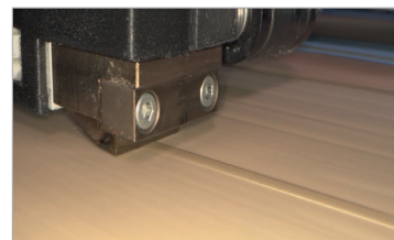
Milimetrowa dokładność i równomierne nanoszenie kleju
