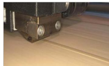
Millimetergenauer und gleichmässiger Klebstoffauftrag
