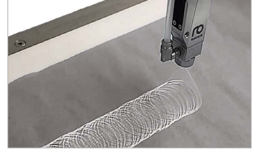
Hassas soğuk tutkal döngüsel uygulama, proses güvenilirliğini sağlar
