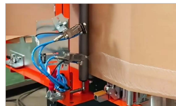
紙製パレットラッパーに搭載されたPolarisスプレーヘッド
