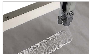
コールドグルーの正確な渦巻き状塗布により、高プロセス信頼性を実現
