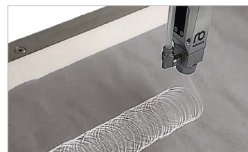
L'applicazione precisa della colla a freddo a spirale garantisce l'affidabilità del processo
