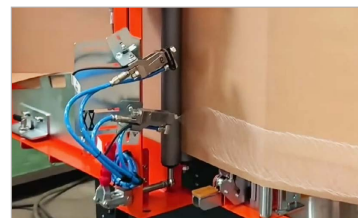
Pistole applicatrici Polaris impiegate per l'avvolgimento di pallet in carta
