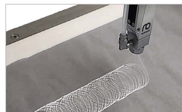
L'application précise de colle à froid en spirale garantit la fiabilité du processus
