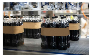
Papier-Banderolierung: Recyclingfähige Stabilisierung von Multipacks
