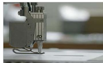
Sempre für Raupenauftrag zur Boden- und Seitenverleimung
