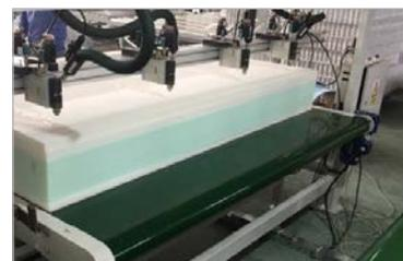
Aplicación de pulverización sobre la espuma
