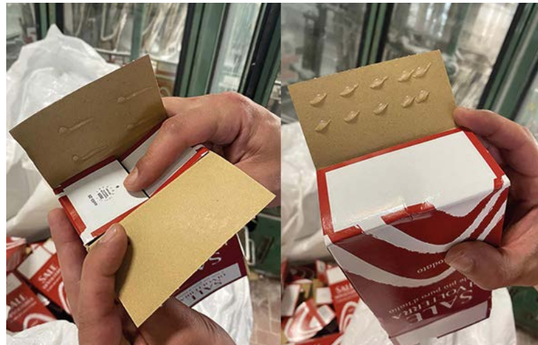
Tuz ambalajının taban kanatlarına yapıştırıcı sürülmesi.
