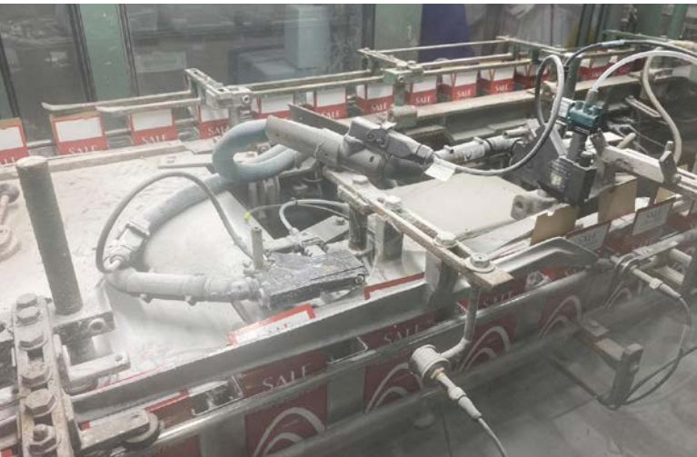
SX Diamond püskürtme başlığı, zorlu üretim koşullarında bile yapıştırıcı şeritlerini güvenilir bir şekilde uygular.
