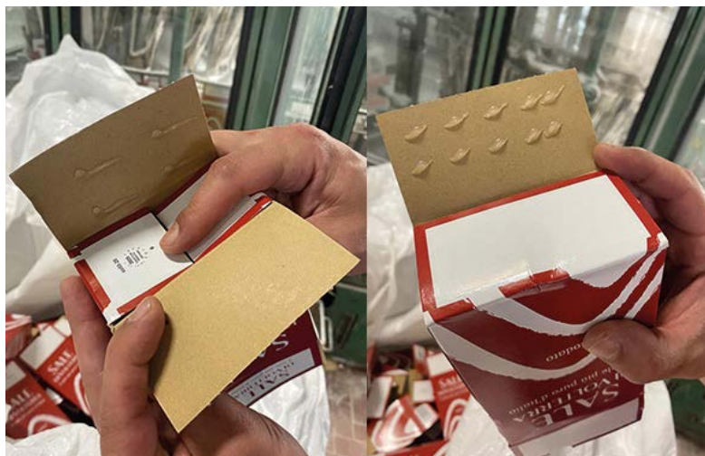
Nakładanie kleju na skrzydełka podstawy opakowania soli.
