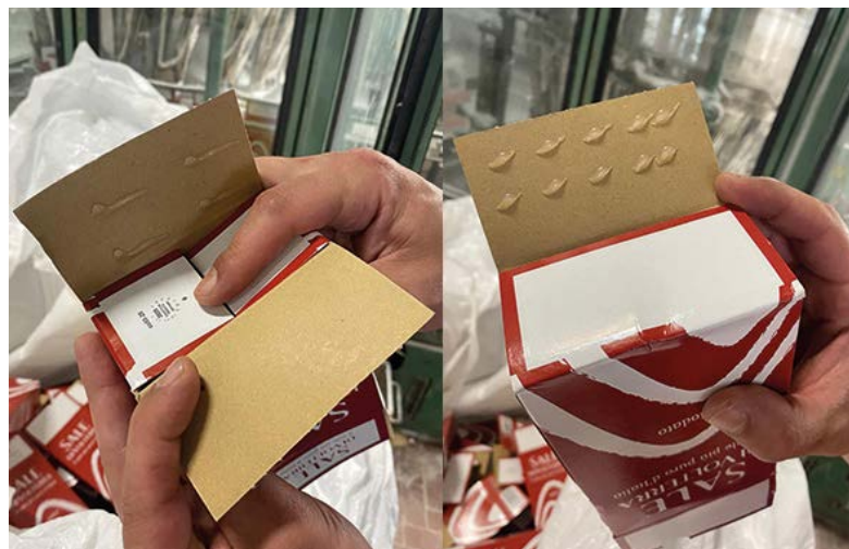
塩の包装の底のタブに接着剤を塗布。
