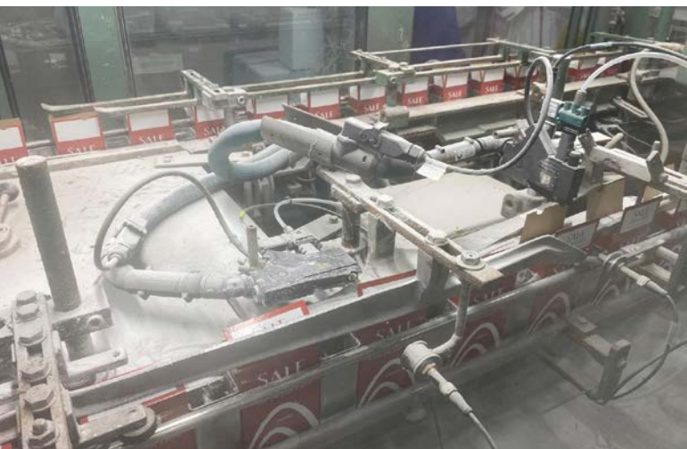
El cabezal de aplicación SX Diamond aplica de forma fiable cordones de adhesivo incluso en condiciones de producción difíciles.
