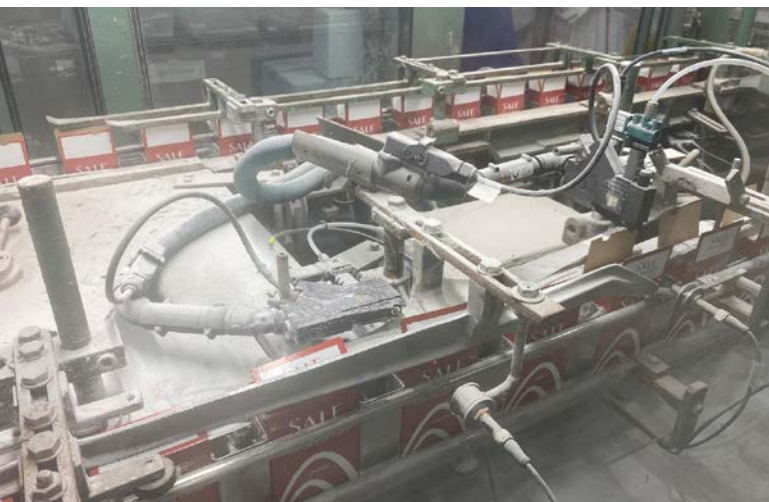
Der Spritzkopf SX Diamond trägt selbst bei rauen Produktionsbedingungen Klebstoffraupen zuverlässig auf.
