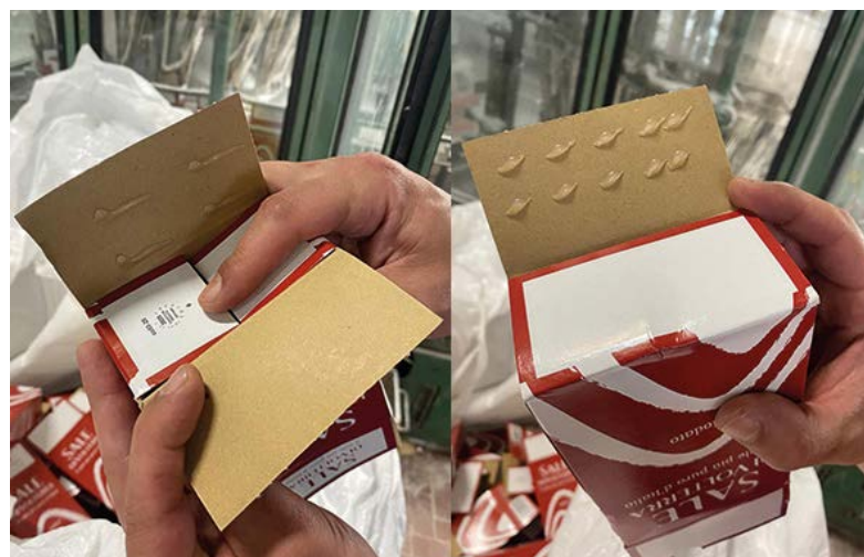
Klebstoffauftrag auf die Bodenlaschen der Salzverpackung.
