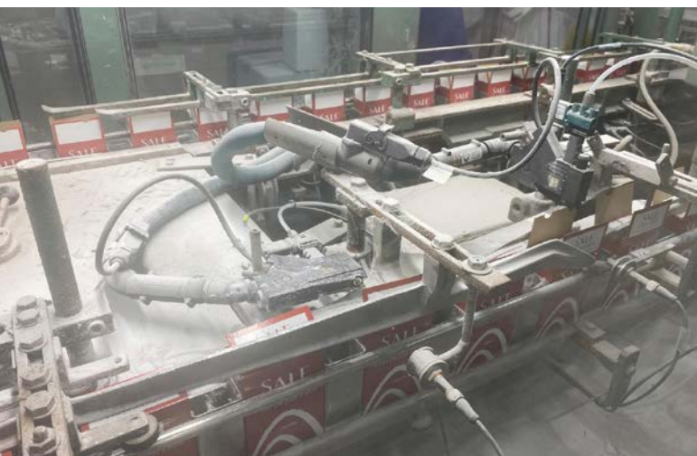
即使在恶劣的生产条件下，SX Diamond 喷头也能可靠地涂覆胶条。
