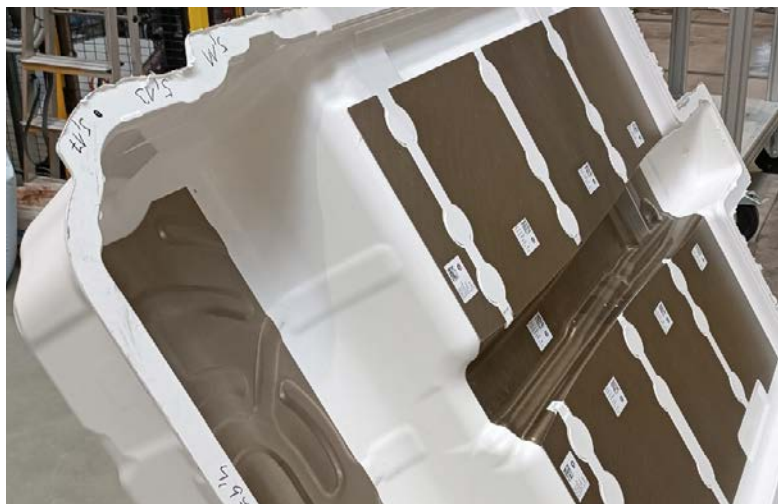
È possibile incollare lastre di mica di diverse dimensioni utilizzando Aero senza cambiare l'ugello, nonostante siano necessarie quantità variabili di adesivo.
