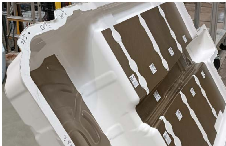
Les plaques de mica de différentes tailles peuvent être collées à l'aide de la tête d'application Aero sans changer de buse, même si les quantités de colle nécessaires varient.
