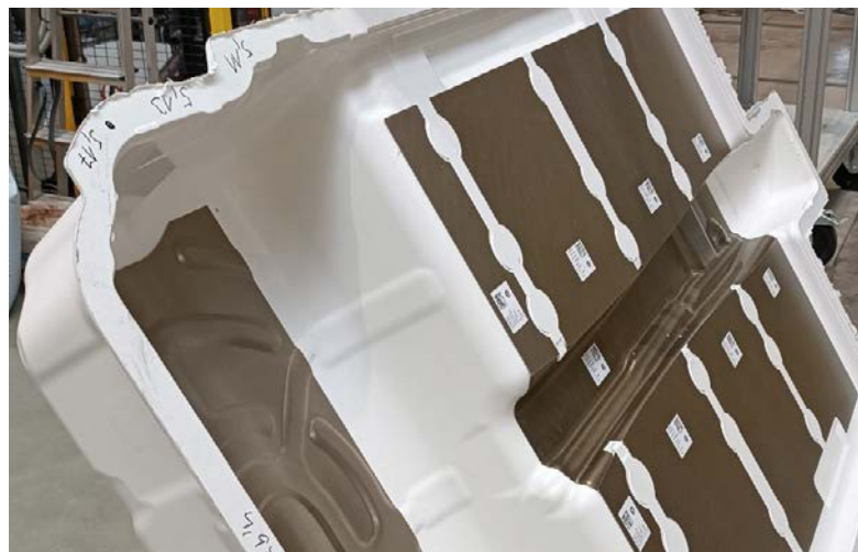
Las placas de mica de diferentes tamaños se pueden pegar con Aero sin cambiar la boquilla, a pesar de que se requieran cantidades variables de adhesivo.
