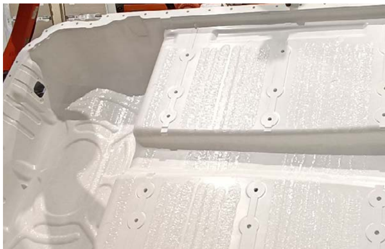
Randgenauigkeit, Präzision und Wiederholgenauigkeit sind Qualitätsmerkmale im Kringelauftrag
