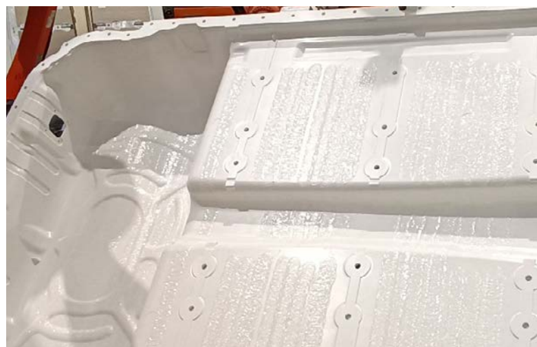
精度、重复性和边缘精度是螺旋喷涂工艺质量的标志。
