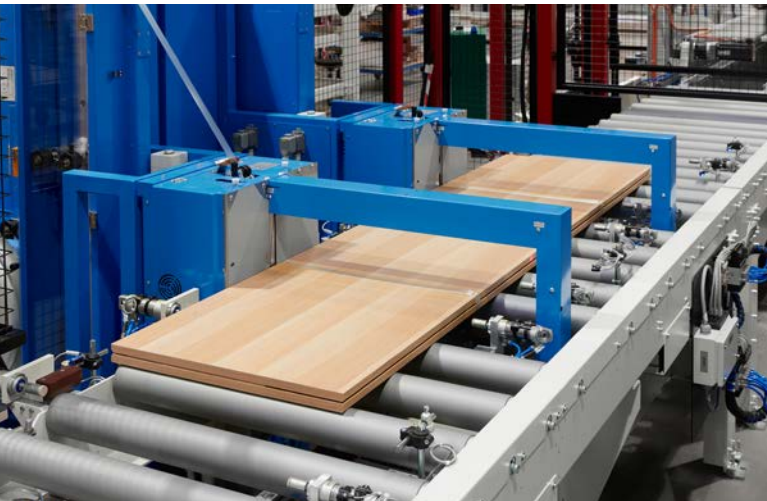
İlk adım: Yan paneller, arka panel ile birlikte hizalanır
