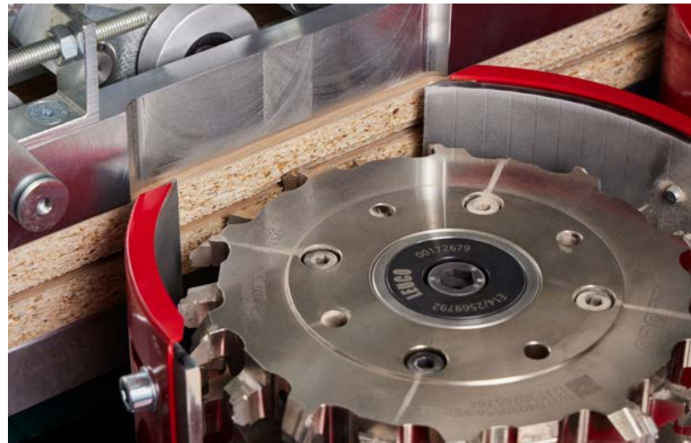
İkinci aşamada, yan panellere hassas bir birleşim kanalı frezeleme yöntemiyle açılır.
