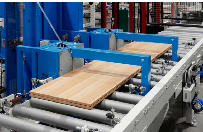
Pierwszy krok: Panele boczne są wyrównane razem z panelem tylnym
