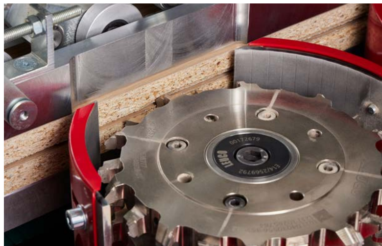
Drugi krok: Precyzyjne połączenie jest frezowane w ścianach bocznych
