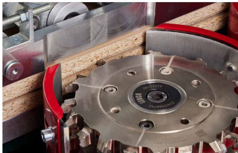
Seconda fase: giunto fresato nelle pareti laterali.
