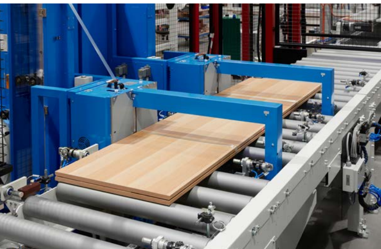
Prima fase: i pannelli laterali vengono allineati con il pannello posteriore.
