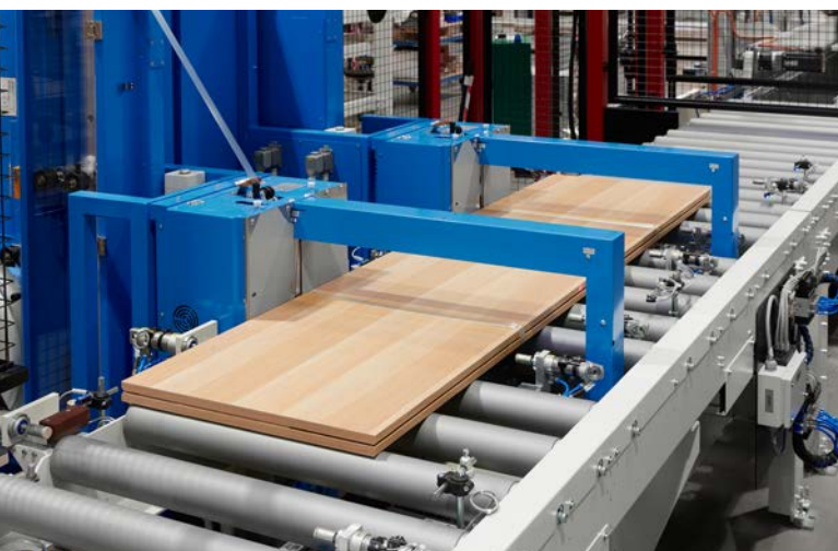
Première étape : Les panneaux latéraux sont alignés avec le panneau arrière.
