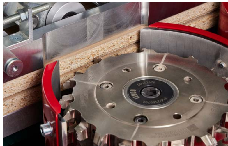
Segundo paso: Se fresa una junta precisa en las paredes laterales
