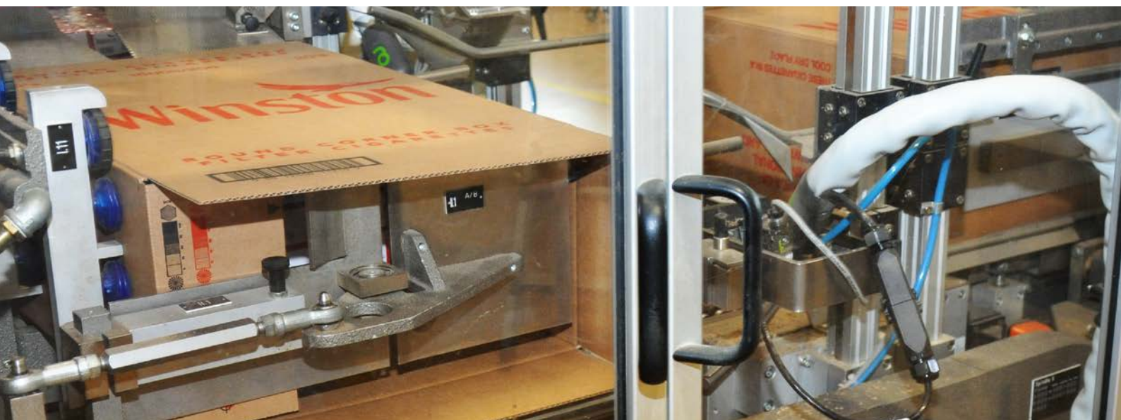
カートンフラップが折りたたまれ (左)、続いて接着されます (右)
