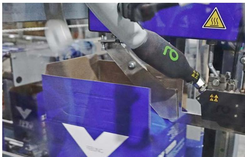
Tuyau chauffant Performa et tête d'application AX Diamond
